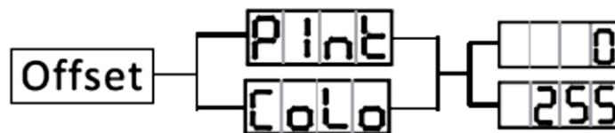
Para entrar en el submenú de ajuste inicial, pulse el botón ENTER durante al menos 5 segundos. En este submenú tendrá la posibilidad de ajustar las posiciones originales de desplazamiento lateral y de la rueda de gobo.
